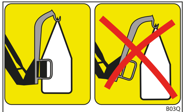
Rys. 79 Prawidłowe (po lewej) i nieprawidłowe (po prawej) ustawienie osprzętu
